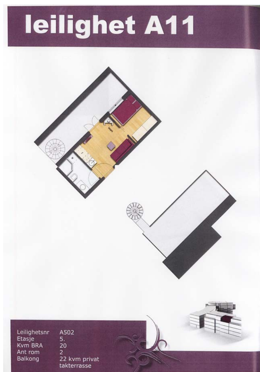
Figur 7.2 Planløsning av bolig i M-X. Planen viser en toroms bolig på 20 m 2 BRA. Soverommet er lite, men antyder likevel at dette skal være et parsengsoverom med dobbeltseng
