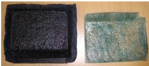
Figur 4-8 Komposittmaterialer laget av tekstilavfall 151
