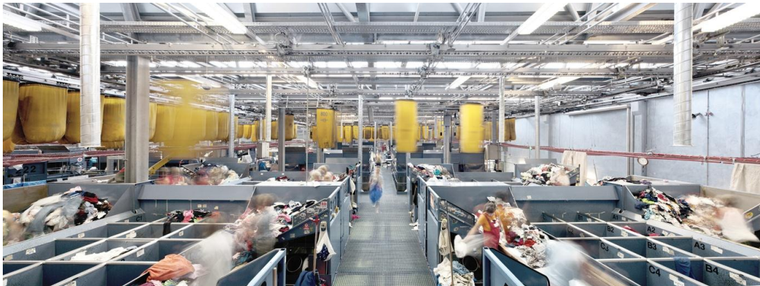
Figur 4-2 En stor sorteringslinje for tekstiler med automatisk materialhåndtering, men manuell sortering 125
