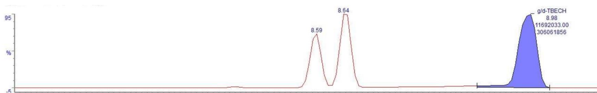
Figur 39. Kromatografisk fremvisning av a, b og g/d TBECH som illustrerer at g og d TBECH kommer ut ved samme retensjon
