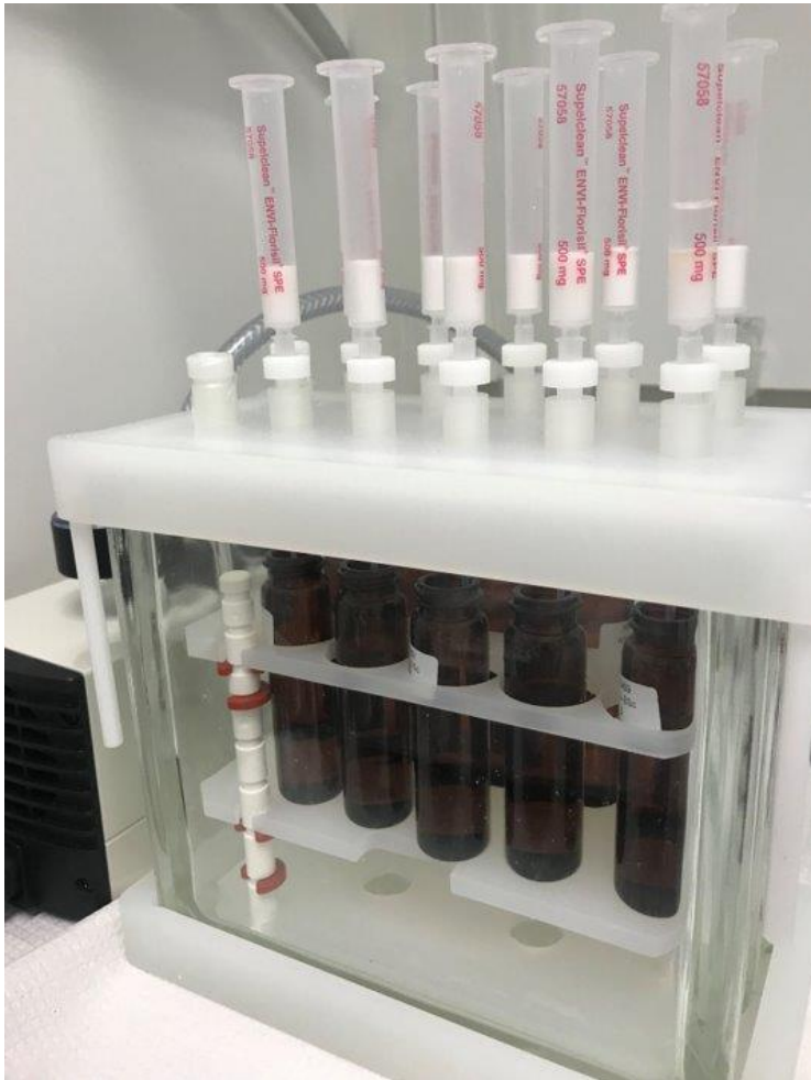
Figur 15. Bilde av ferdig montert ENVI-Florisil kolonne
