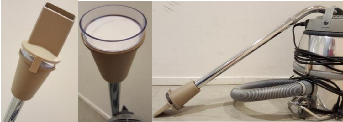
Figur 11. Prøvetakingsutstyr for prøvetaking av gulv støv i innendørs boligmiljø. Foto gjengitt med tillatelse av Pernilla Bohlin-Nizzetto ved NILU.
