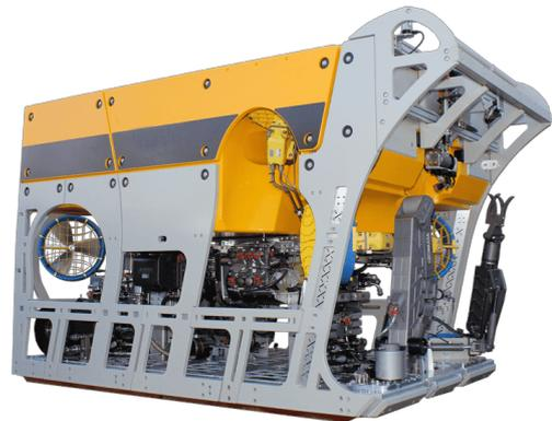
(d) Heavy work class ROV: Schilling UHD III (ROVOP, 2023)
