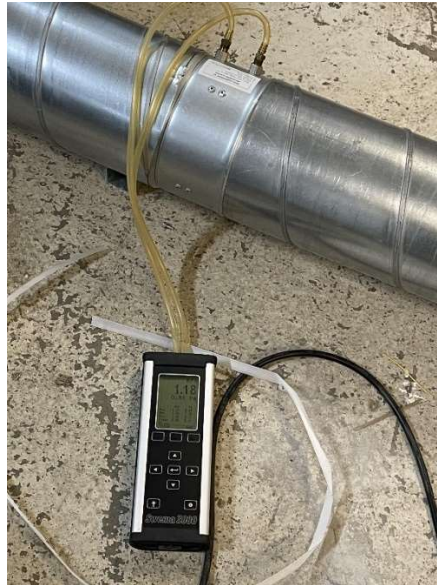
Figur 3.3-3(Swema koblet mot BAAS)
