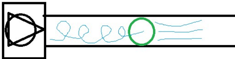
Figur 3.2.2-4 (luftprofil før og etter luftretter)
