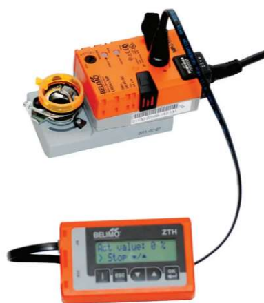
Figur 2.3.4-2 (ZTH koblet opp spjeldmotor (hentet fra Micromatic))
