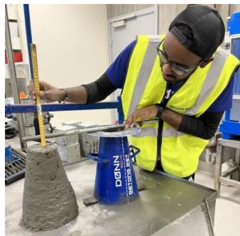
G-10 Måling av Slump
