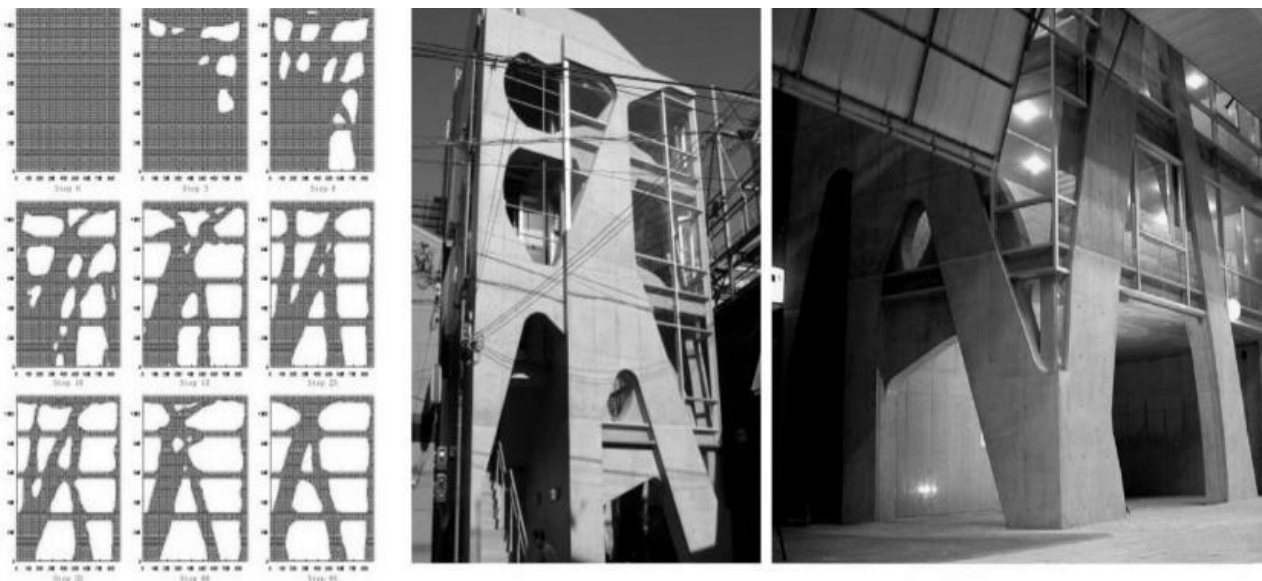
Figur 6-5 prosessen for topologioptimalisering som ble brukt i utformingen av veggene til Akutagawa River Side Office Building
