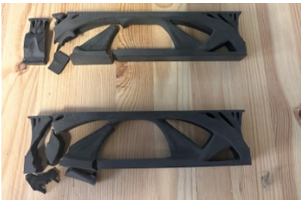
Figur -16 FDM massiv
