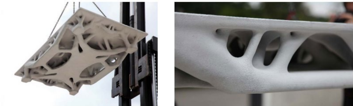
Figur 6-20 SIMP-topologioptimaliseringsalgoritmen til Simulia ABAQUS av en dekke
