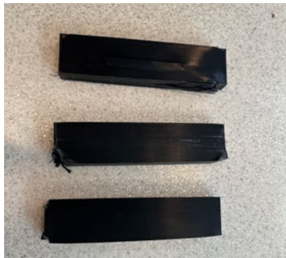
Figur -16 FDM massiv
