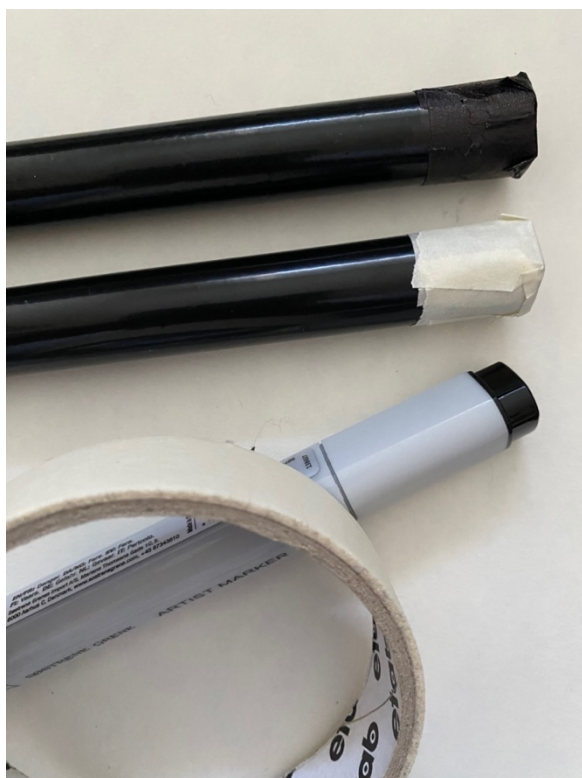
Bilde 10 – prosessdokumentasjon: teiper over den skarpe kanten på metallrøret som har blitt sagt.
