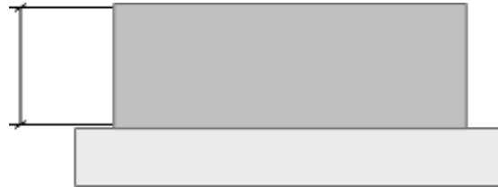
Figur 27: Fordelingslengden til de horisontale bøylene i vegghjørner
