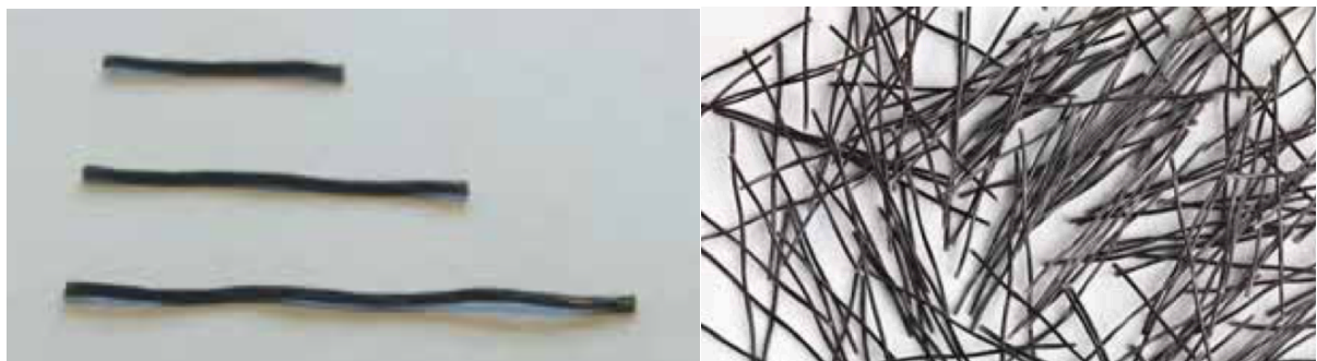
Figur 7 Basalt MiniBars™ med helixform
