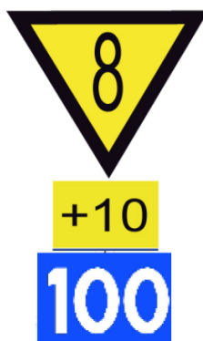
Figur 2-12 Blått underskilt: Signal 68G Hastighet for krengetog.
