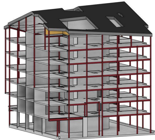
Figur 4.1: Opprinnelig bærekonstruksjon, Revit
