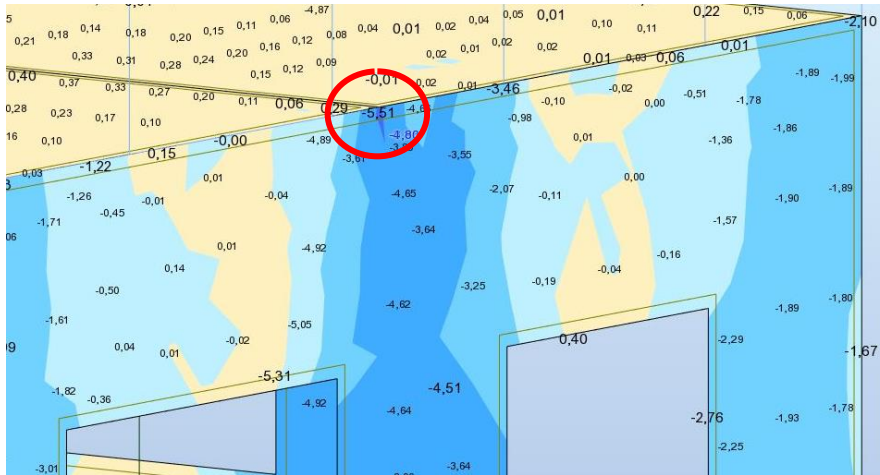
Figur 4.28: Trykkspenning fra drager på gavlvegg, Robot
