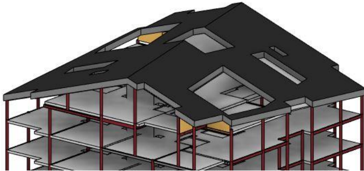
Figur 4.39: Utklipp av takkonstruksjon, Revit
