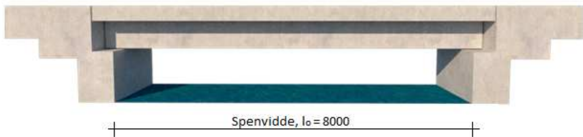
Figur 4.1-1: Lengdesnitt av analysemodellen. Spennvidde = 8000 mm.
