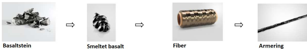
Figur 3.2-7: Viser trinnene i produksjonsprosessen av basaltarmering. Kilde: ReforceTech.
