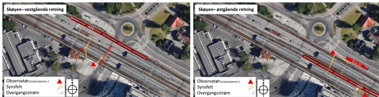
Figur 0.4: Metode for overgangstelling på Skøyen mellom tog L22 og buss 31
