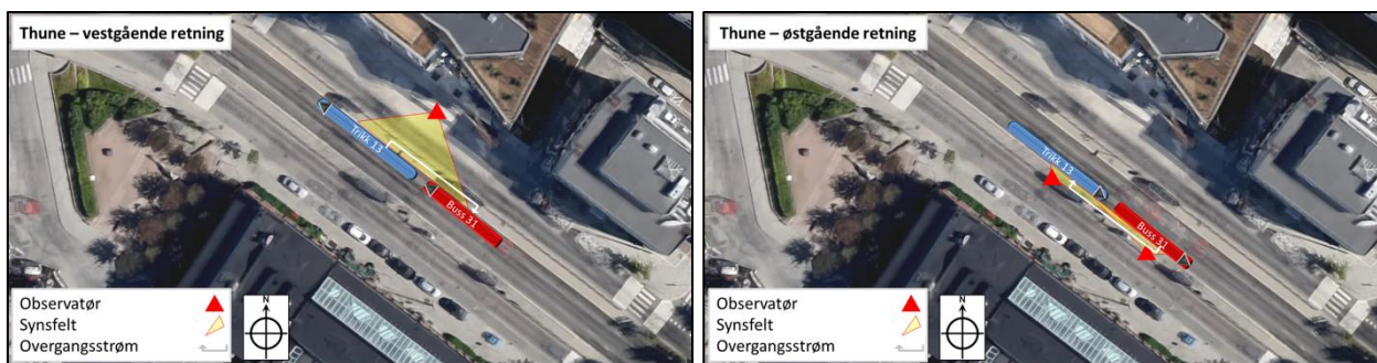
Figur 0.2: Metode for overgangstelling på Thune mellom trikk 13 og buss 31
