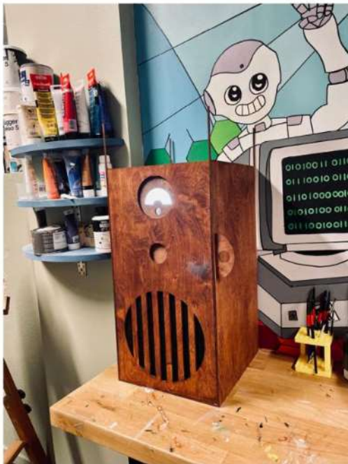
Bilde 9-11. Den endelige versjonen av kameraet med subwooferen den innebygde camera obscuraet, og den lille bevegelsesstyrte lampen.
