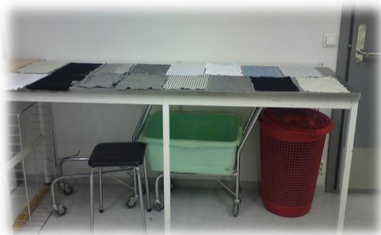
Figur 5. Lufting av prøver. Prøvene ble også tørket etter vask på samme måte.
