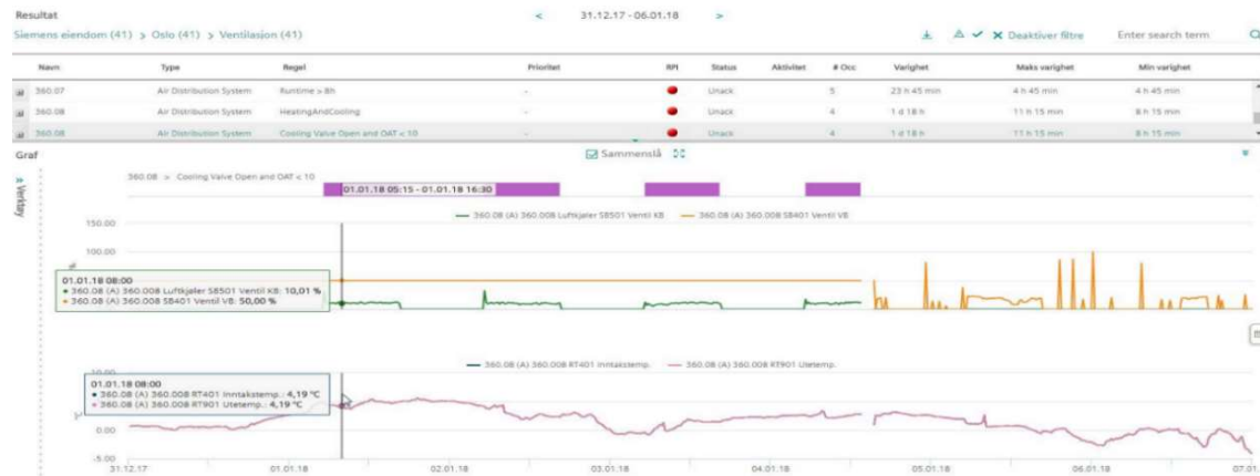
Figur 35 skjermbilde av energianalyse på ventilasjon aggregat
