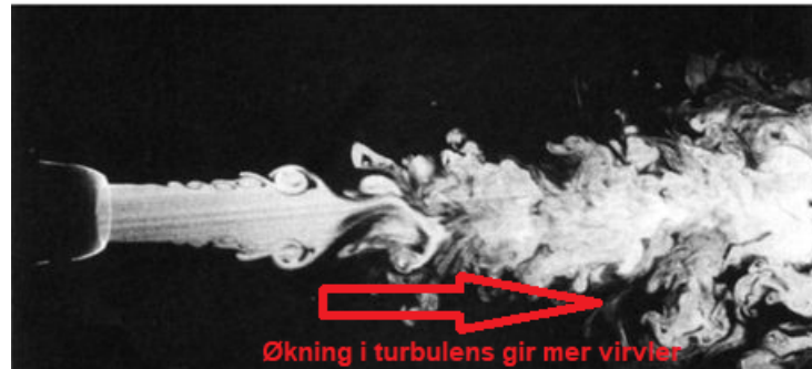
Figure 6.2: En fremstilling av hvordan virvler oppstår og hvordan de bidrar til turbulent strømning
