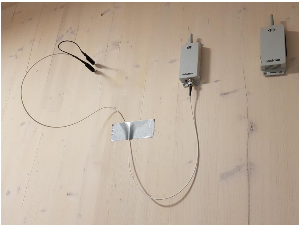
Figur 2.15: viser bilde av MC501 med fuktgiver og skruerinnfesting 1 cm dybde montert i sone 3/ soverom nord. TH500 er montert til høyre for MC501.
