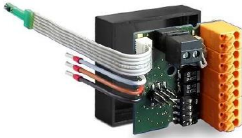
Figur 2.6: Bilde viser komponenter i Lunos 5-UNI-FT bryter med føler for luftfuktighet [13]
