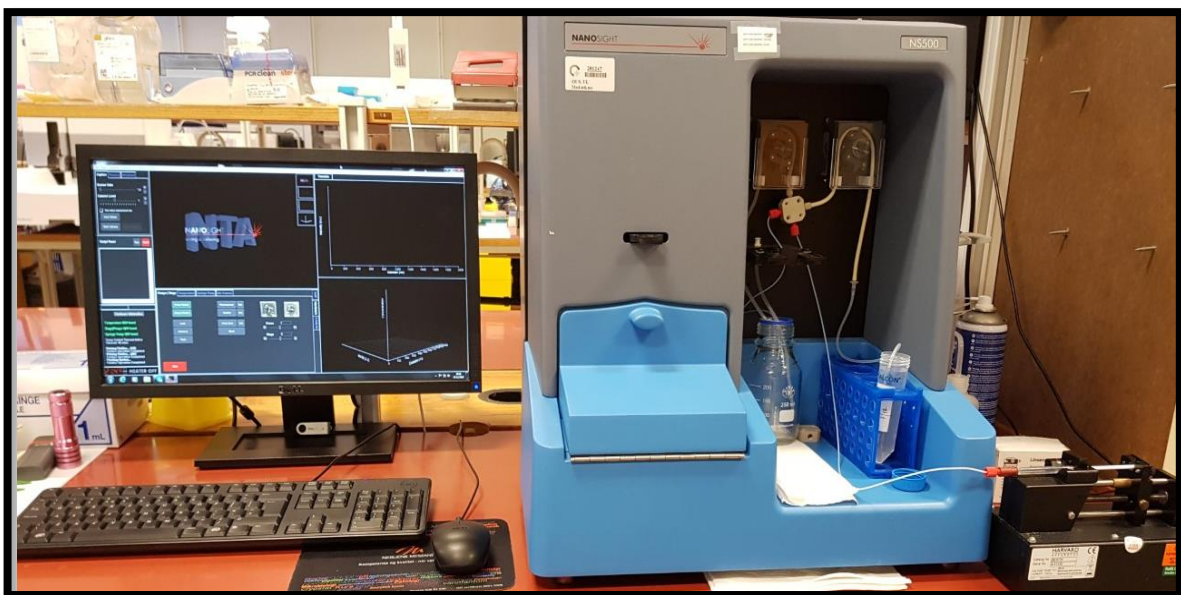
Figur 2.7: NanoSight NS500 instrumentet er koblet til en injeksjonspumpe med prøveløsning og videre koblet til en PC med NTA-programvare (versjon 3.2). Foto: Mobilkamera Samsung Galaxy 8.
