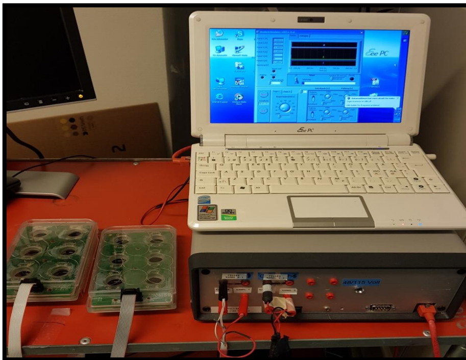
Figur 2.3: Apparaturl til elektrisk pulsstimulering (EPS) av muskelceller. To 6-brønnersbrett dekket med C-dish lokk (Ionoptix) som har karbonelektroder stikkende ned i differensieringsmediet. Elektrodene er koblet til en stimulator som justeres fra en PC med egenutviklet programvare. Foto: Mobilkamera Samsung Galaxy 8.
