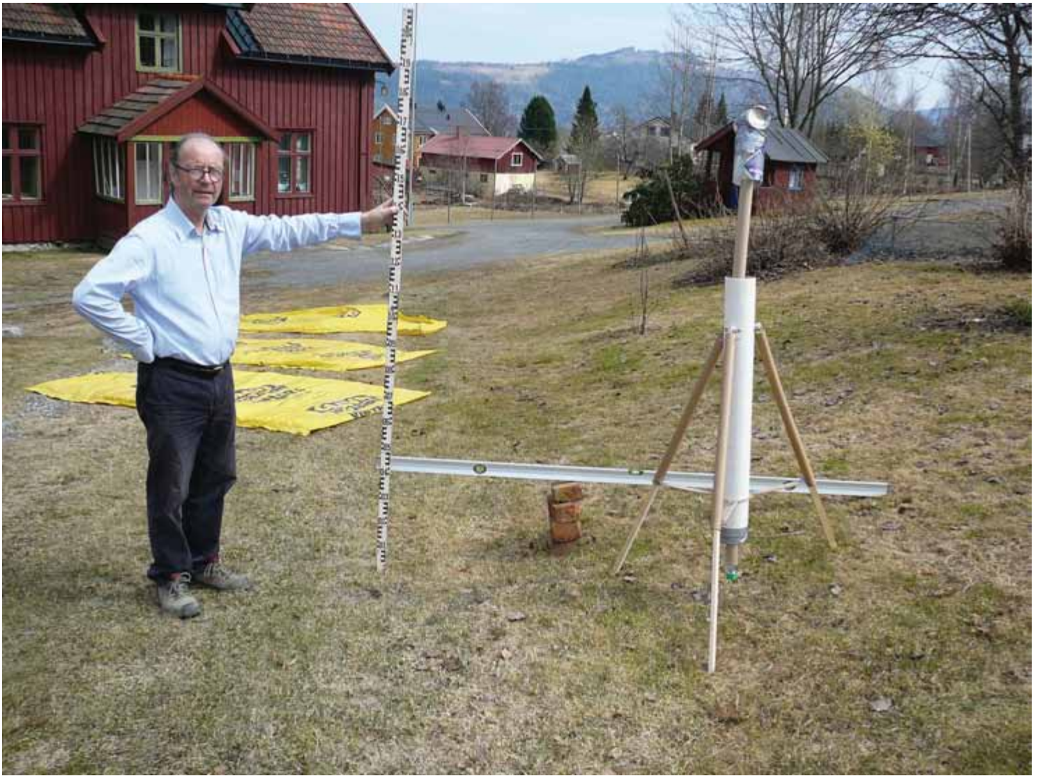
Fig. 6.16 Helningsberegning vha. vater og tommestokk
