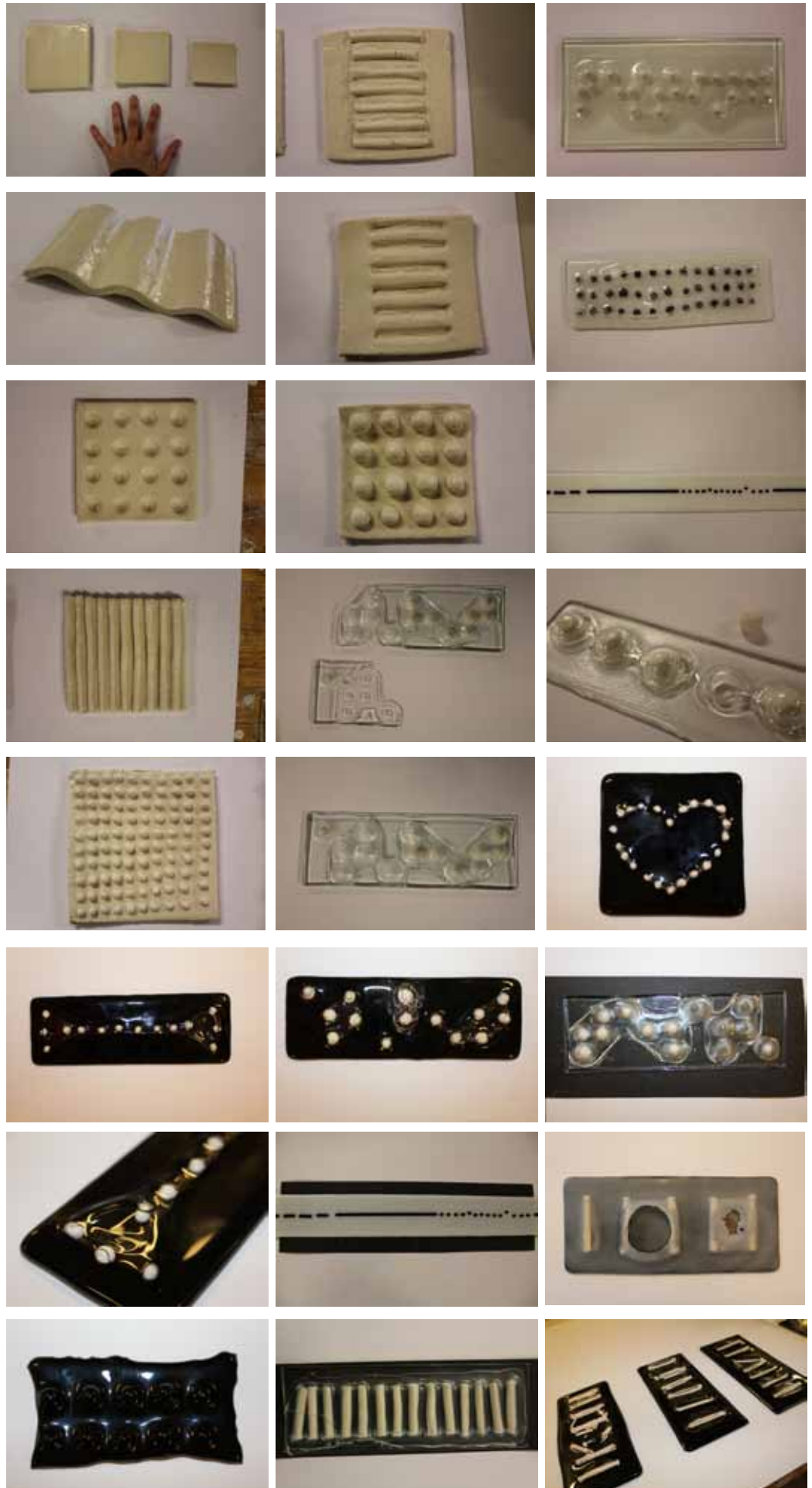
På bildet: Flisene som ble laget på bakgrunn av hva de synshemmede ved Blindeforbundet i Oslo ønsket. Knust prøver vises ikke.
