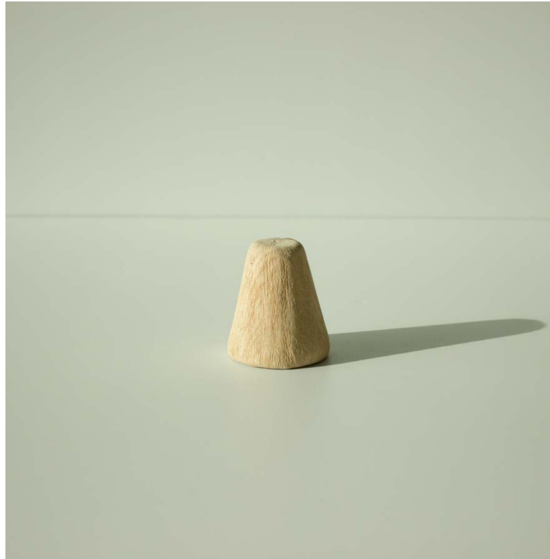
Tekstur som fremhever treverkets ulike hardheter fra børsting med stål
