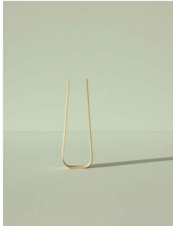
Materialets bøyelighet testet med dampbøying
