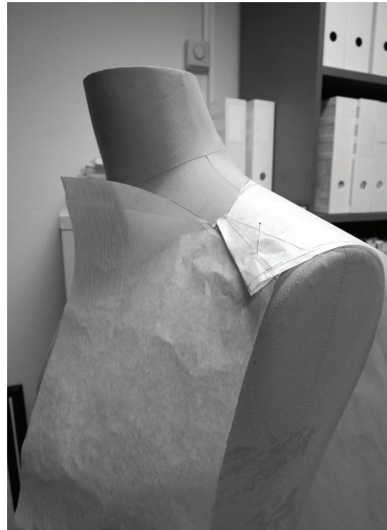
Stor byste: Mønsterkonstruksjon av oppoverbuet halsutringning 2.forsøk
