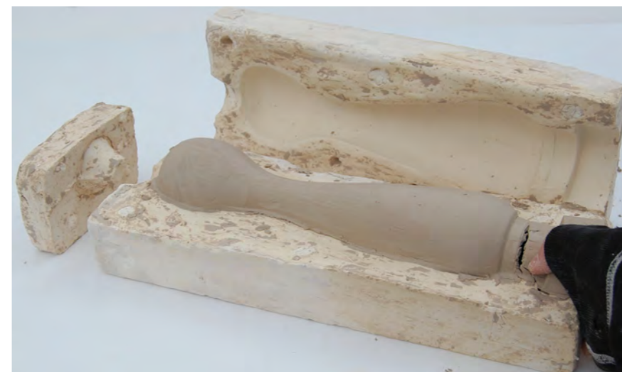
Støpeform som kan benyttes begge veier, slik at jeg kan støpe hele formelementet, eller bare nederste del. En plugg kan settes på både øverst og nederst.
