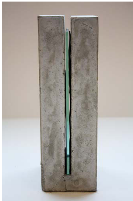
Prøve med list mellom betong og glass. For at glass ikke skal ligge inntil betongen.
