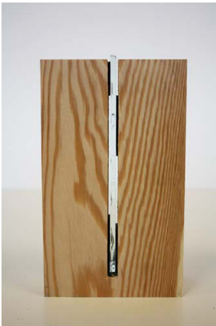
Prøve med list mellom tre og glass. For at glass ikke skal ligge inntil impregneret tre og oksidere.
