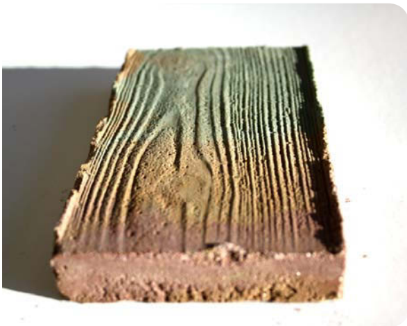
Betong støpt mot sandblåst tre.
