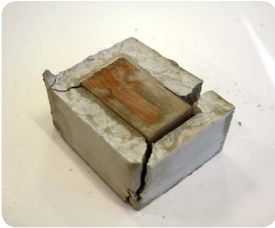
Bøk støpt i betong
