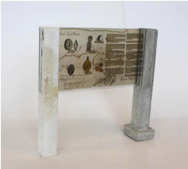
Hvit betong og grå betong. Hvit betong blir fort skitten.
