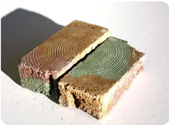
Betong støpt mot årringer. Kan også se ut som vannringer.
