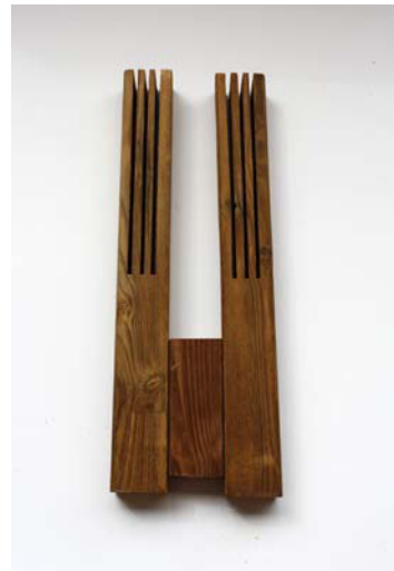
Modellene har ligget ute i 9 dager. Treet har ikke bevæget seg mye, og fargen har endret seg
