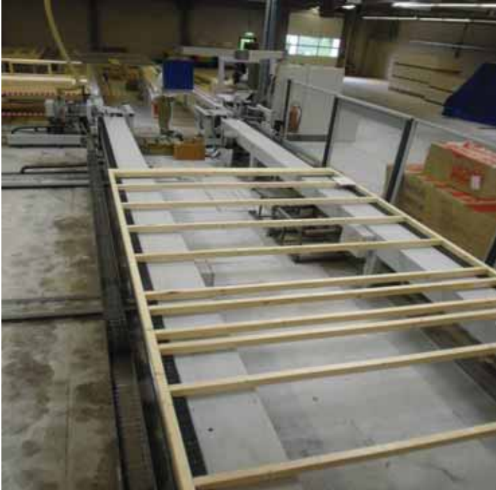
Figur 9.8 Veggemne på vei mot neste stasjon, der fukt og vindsperre monteres manuelt. Foto Moelven
