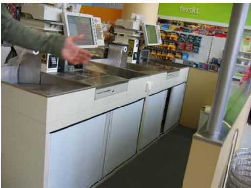
Hyllene er utstyrt med en følsom vekt som registrerer når en pakke fjernes. Denne må kvitteres ut med strekkodeleser for at ikke alarmer skal gå
