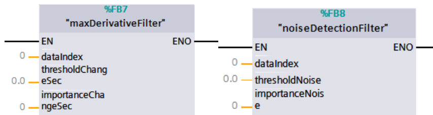
Figur 37: Bilde av funksjonsblokkene for de fire filtrene
