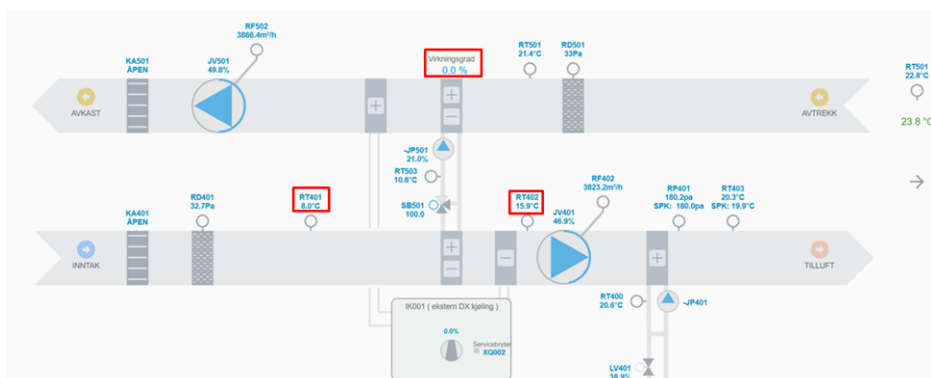
Figur 3-2: Systemskjema ventilasjonsaggregat 360.019- hentet fra SD-anlegget.
