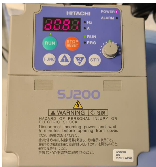
Bilde 12: Hitachi SJ200 hastighets kontroll til vindtunnelen
