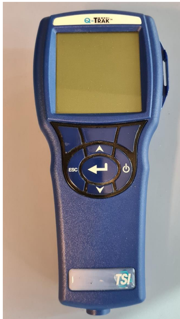
Bilde 3: Q-Trak 7565 måleinstrument
