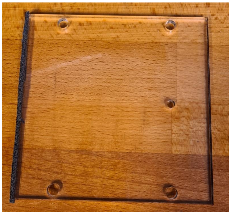
Bilde 20: Egen laserkuttet sideplate til vindtunnelen laget spesifikt for bruk av prandtlrør
