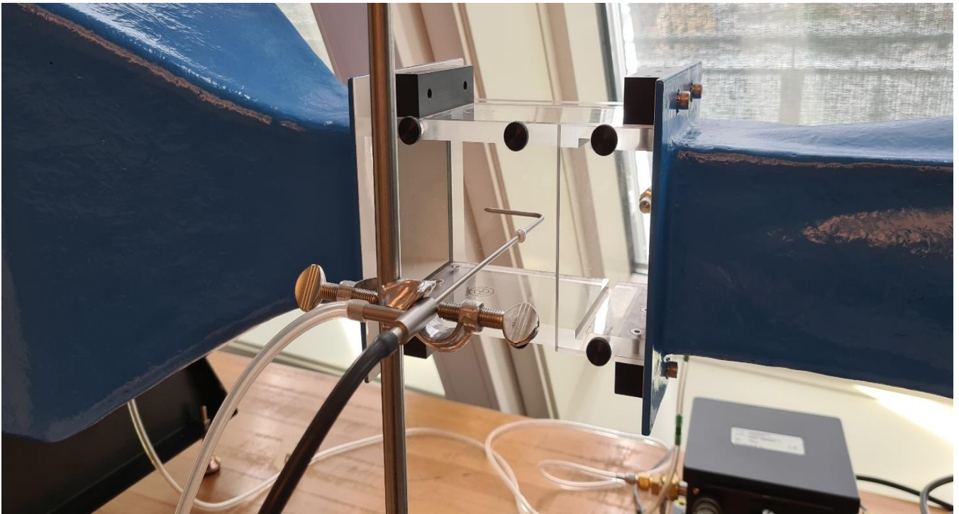
Bilde 18: Ytelsesverifisering med Prandtl-rør
