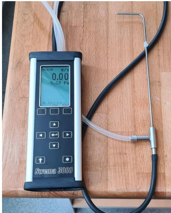
Bilde 19: Oppkobling av Prandtl-rør og Swema 3000 med trykkledninger
