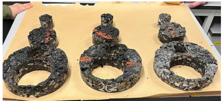
Figur 3.2-2 Til venstre: Opprinnelig størrelse på borkjerner. Til høyre: Prøvestørrelse etter boring i laboratoriet.
