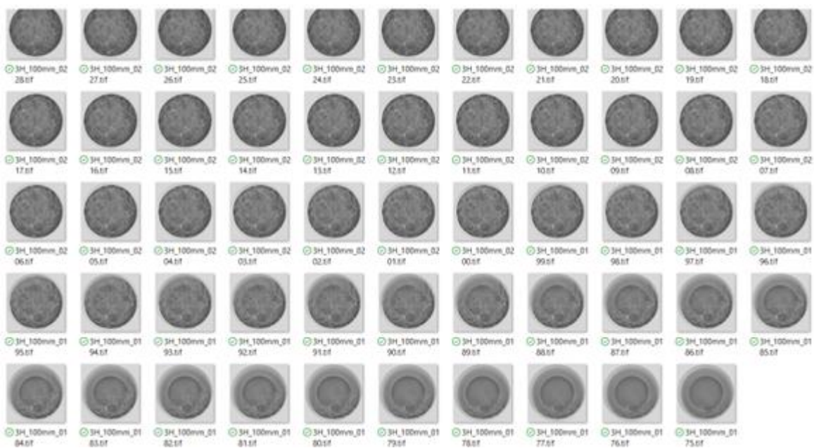
Figur 3.2-9 Oversikt over tverrsnittbilder fra bunnen av prøve 100mm 3H
