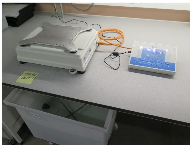
Figur 3: Vekt med tilhørende vannbad for CoreLok og hydrostatisk måling.
