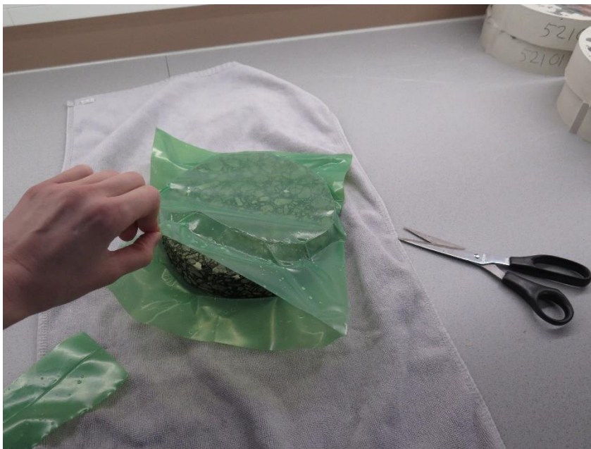
Figur 7: Tørking og klipping av prøve på håndduk.
