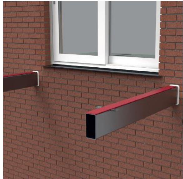
Figur 4.7 (Invisible connections AS, 2019a) «Ytre vanntetting»
