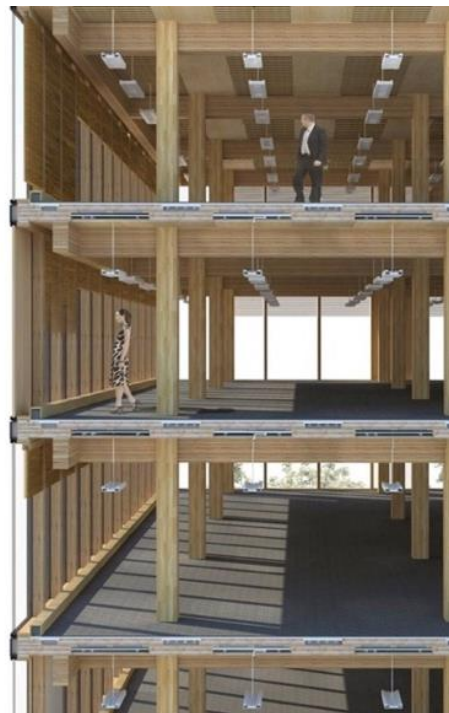
Figur 2.9: Bæresystemet av WIDC
