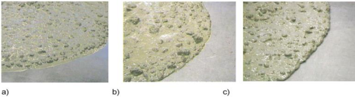
Figur 5 a), b) og c). Ustabil (a), stabil (b) og meget stabil (c) SKB, målt med utbredelsesmetoden. Viser hvordan man kan vurdere stabilitet ved kantbedømmelse. (Busterud et. al., 2007, s. 9)
