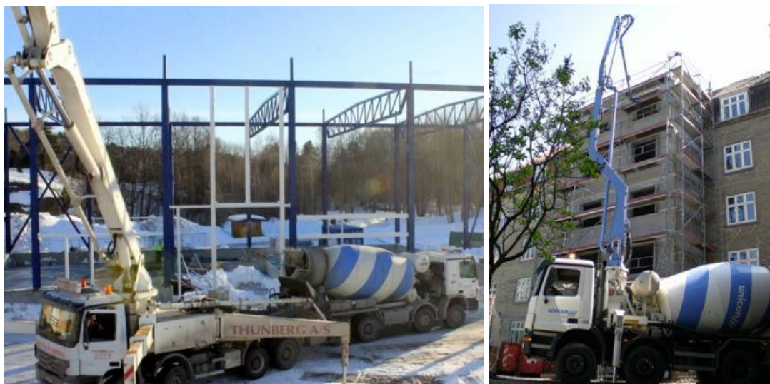
Figur 2.5 a) Dedikert pumpebil (Pumpebil, 2011), b) PUMI - Betongbil med påmontert pumpe. (PUMI, udatert)
