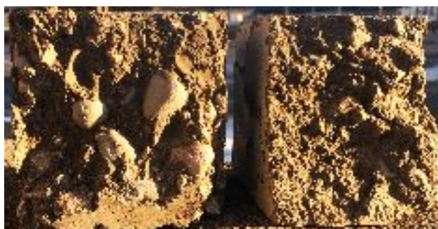
Figur 5.11 Trykktestede terninger, useparert betong til venstre og separert betong til høyre.
