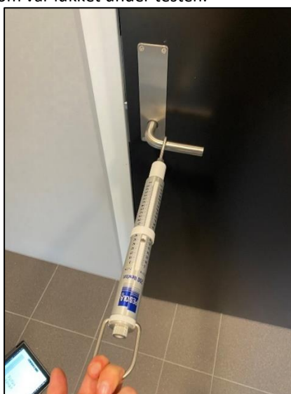
Figur 28: Måling av døråpningskraft.
