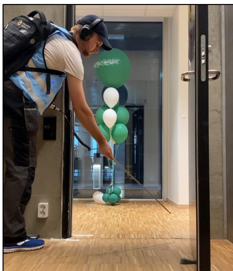
Figur 26: Måling av lufthastighet ved andre etasje, B1
