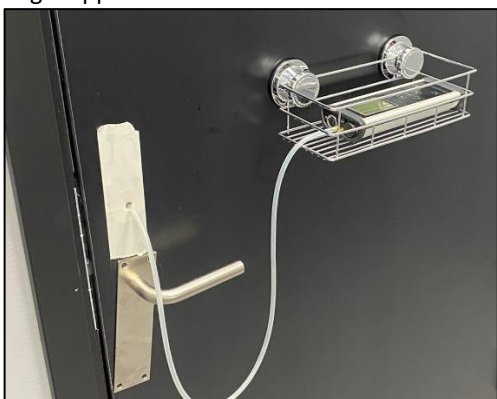
Figur 19: Trapp D2 hadde gode forutsetninger som tillot enkel rigging. Bak vrideren eksisterte en ubrukt utsparring til låsesylinder.
