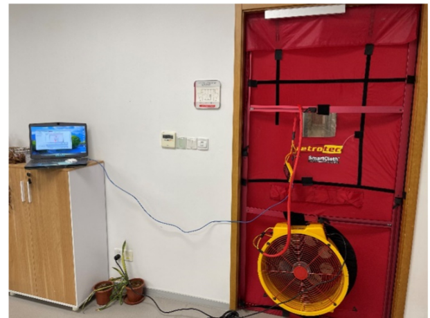
Fig. 2. The blower door test system.
