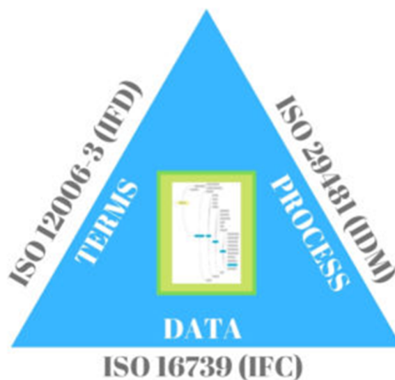
Figur 8 Grafisk fremstilling av samspillet mellom IFD (bSDD), IFC og IDM som grunnlag for å beskrive et byggverk. [17]
