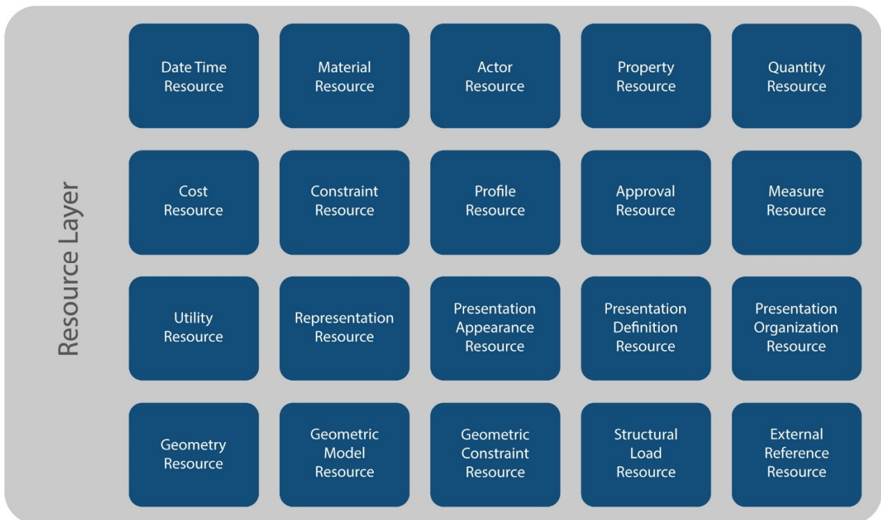
Figur 14 Oppstilling av innhold i ressurslaget i IFC-definisjon. [26]
