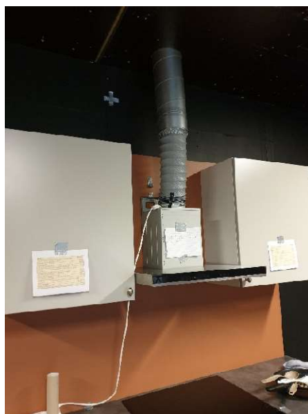
Figur 11: Kjøkkenhetten – uttrekking modus.
