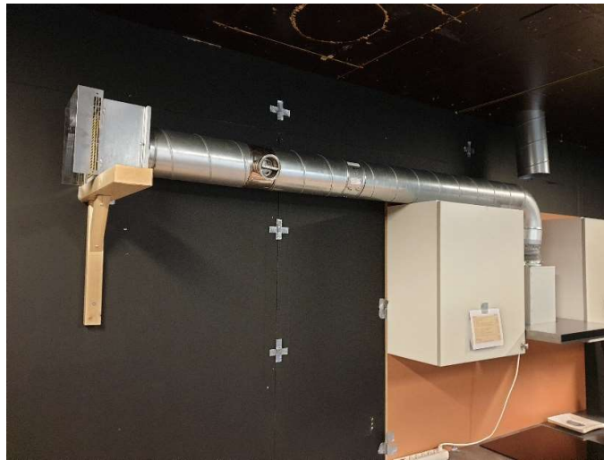
Figur 12: Kjøkkenheten - resirkulerende modus.
