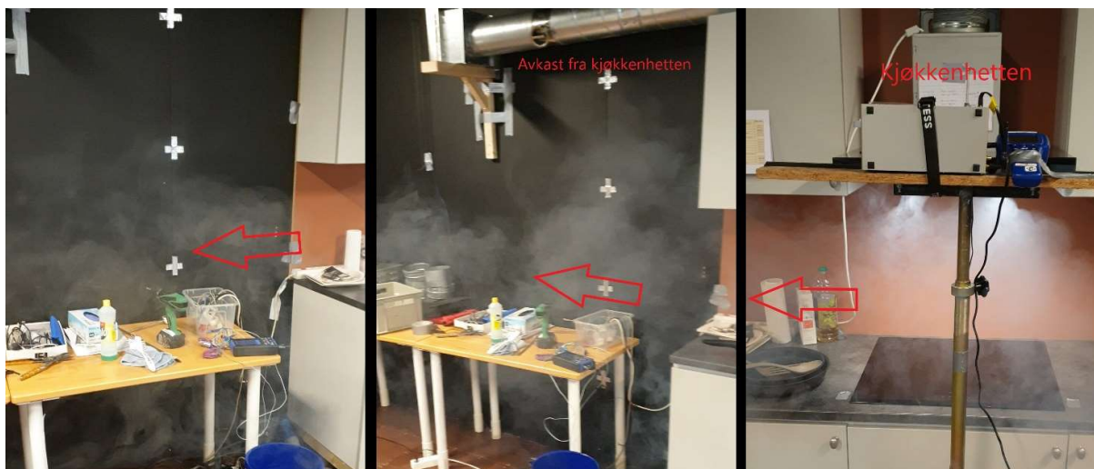
Figur 25: Bilder av resultatene fra røykmaskintesten
