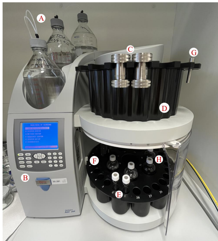
Figur 2: Bilde av Dionex ASE TM 350 og dens deler; A: løsemiddel flasker og pumpe koblet til. B: informasjon panel for innstillinger og ekstraksjon. C: Ekstraksjons celler. D: Roterende holder for ekstraksjons celler. E: oppsamlingsflasker. F: roterende holder for oppsamlingsflasker. G: celle brukt for rens. H: Oppsamlings flasker for vask.
