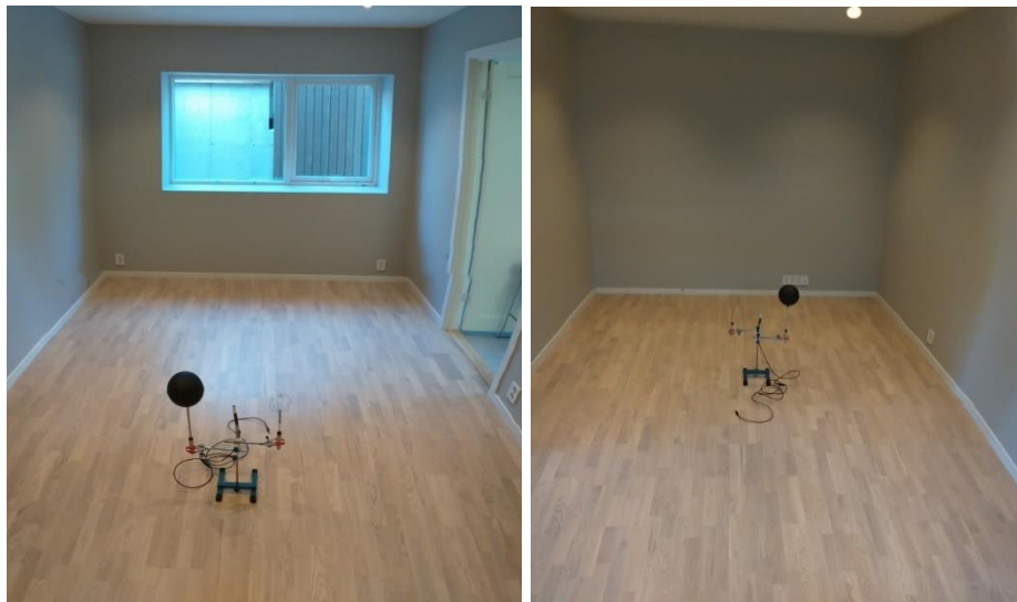
Figur 29: Plassering av Termisk komfort rigg i rommet
