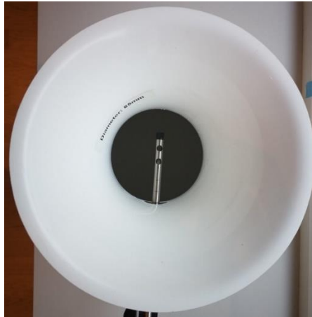
Figur 26: Måletrakt med anemometer
