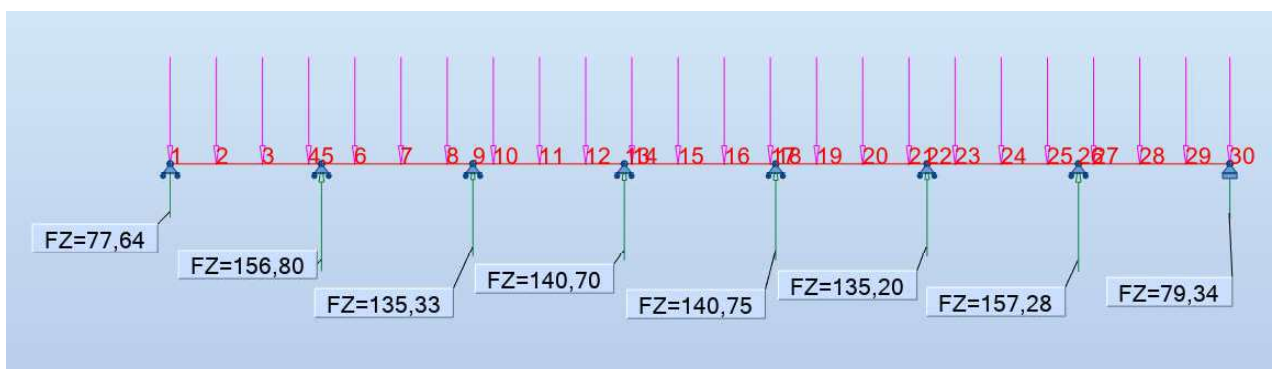
Figur 53: Reaksjonskrefter langsgående IPE 200 bjelke med lengde 28 meter
