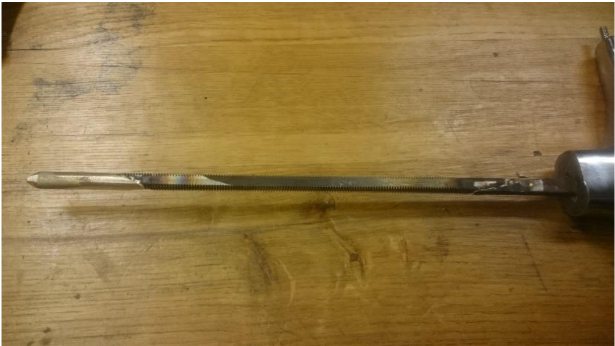
Figur 12: Tangen til Frost sveiset diagonalt på to punkter. Midtseksjonen brukes til å forlenge tangen og endestykket er i messing for å klinge konstruksjonen sammen
