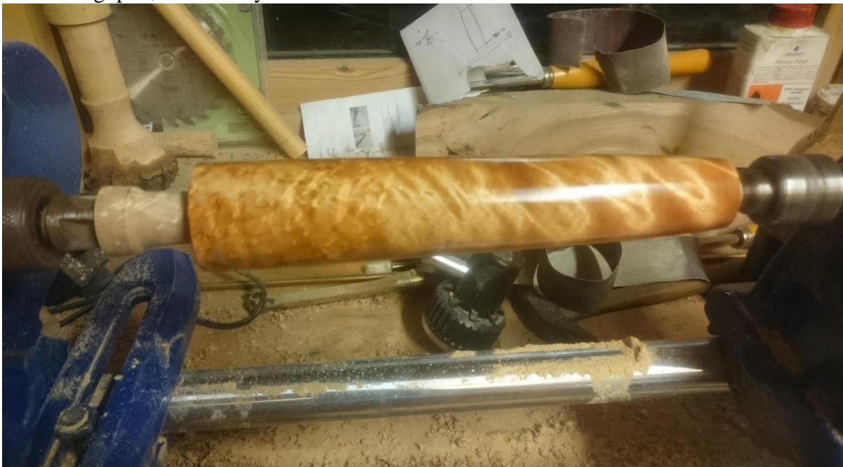
Figur 11: Skaftet til Ice fortsatt på dreiebenken etter forming, pussing, farging av treverket og overflatebehandling
