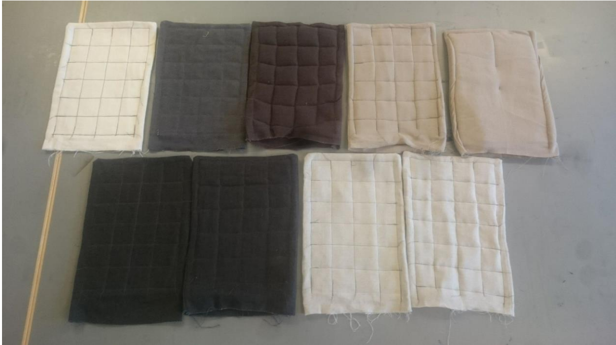
Figur 17: Alle stoffutprøvinger i forskjellige materialer og tykkelser. Fra øverst til venstre: 7 lag bommulslerret, 2 ytterlag lin og viskoseblanding med 10 indre lag i bommulslerret, 2 ytterlag i lin og viskoseblanding med 3 indre lag vatt, 2 ytterlag 100% lin med 5 indre lag ullfilt, 2 ytterlag 100% lin med 10 indre lag ullfilt, 7 lag lin og viskoseblanding, 12 lag lin og viskoseblanding, 7 lag 100% lin, 12 lag 100% lin
