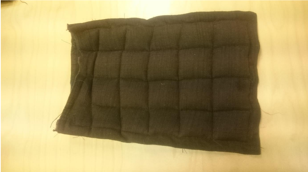
Figur 16: Utprøving med 2 ytterlag i lin og viskoseblanding med 3 indre lag vatt
