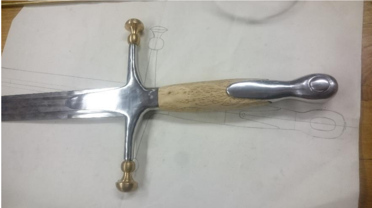
Figur 10: Frost konstruert uten lim. Metalldelene er polert på bildet.
