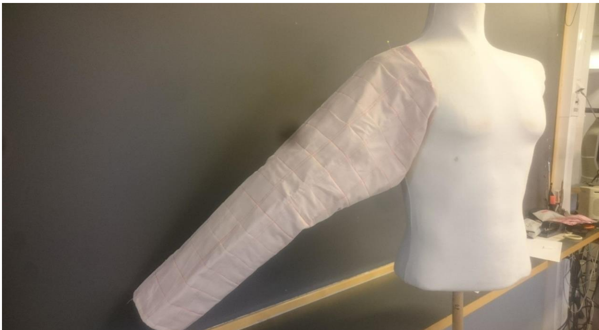
Figur 18: Utprøving av erme til slagkofte. Sydd i 6 lag bommulslerret
