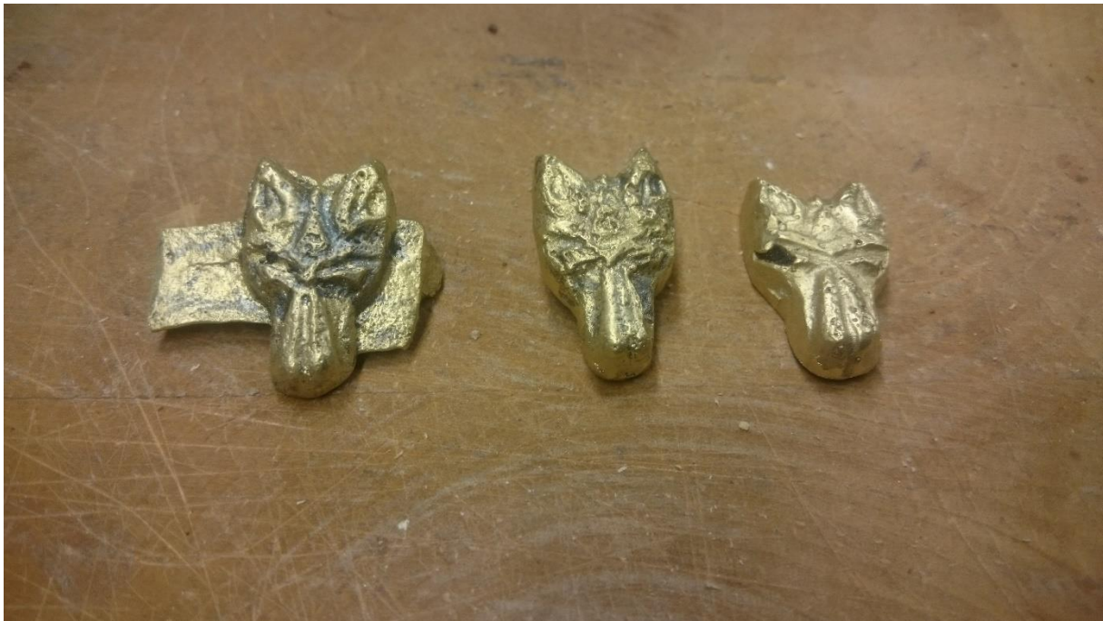
Figur 13: Messingdetalj for beltet i tre stadier i slipeprosessen. Fra venstre: Nylig støpt, unødig materiale fjernet, grovpolert overflate før lodding og finpolering
