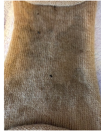
Bilde nr. 120: Viser at det kommer mørke flekker der det er dryppet alun, (foto, Bredesen 2019 ).
