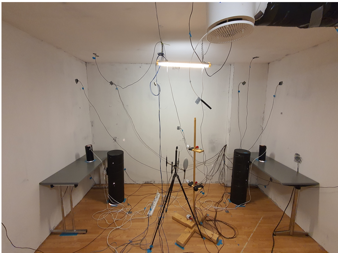
Figur 3.25: Bildet av ferdig opprignet klimarommet for måling med PCM-sparkel
