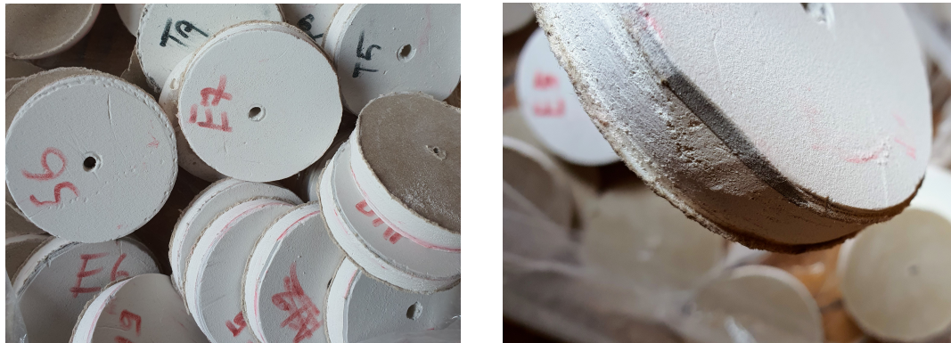
Figur 4.11: Prøvestykker av PCM-sparkel tatt fra klimarommet
