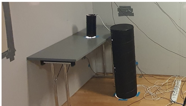
Figur 3.7: Ventilasjonskanal og lyspære brukt som varmetilskudd fra person og utstyr
