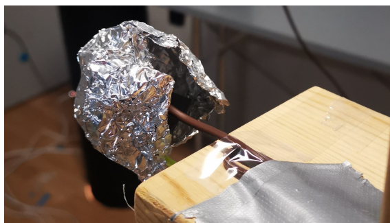
Figur 3.17: Skjerming av termoelement for varmestråling
