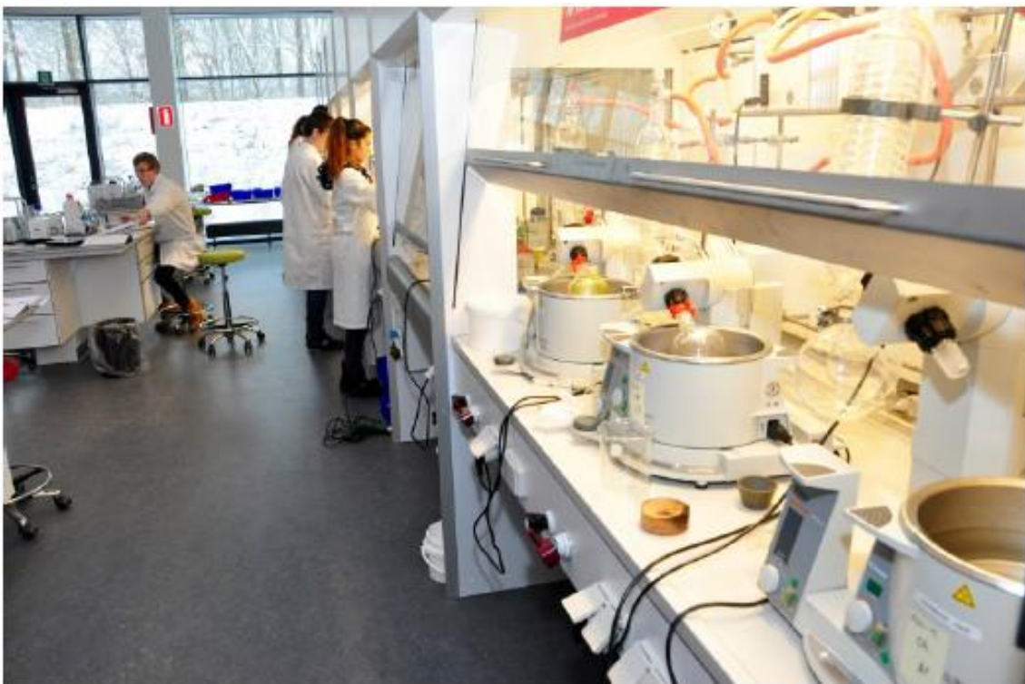
Figur 5 Avtrekksskap benyttet for rotavaporer i undervisningslaboratorium ved DTU. Bilde fra studietur ved DTU (Døhl, 2016).
