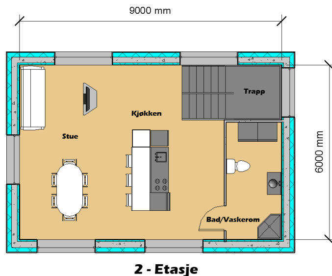
Figur 34 - Planløsning i andre etasje for referanse bygg
