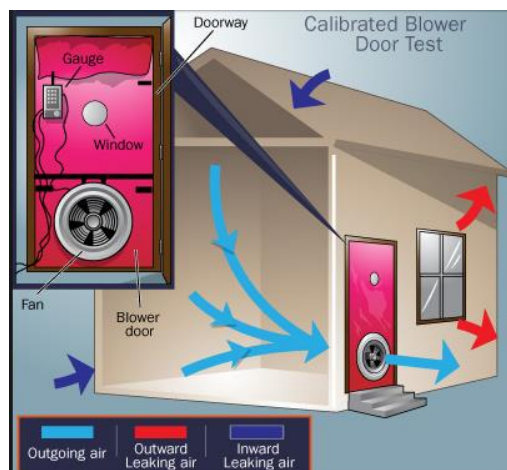
Figur 9. Tryksetting med blower door. Lyseblå piler indikerer luft som trekkes ut via viften, røde piler indikerer eksfiltrasjon og mørkeblå piler indikerer infiltrasjon [38].
