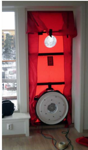
Figur 8. Automatisert vifte/blower door [37].
