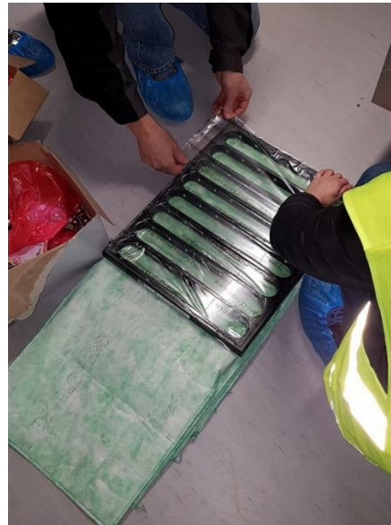
Figur 4. Teiping av filterkasset. [Foto: M. Smidt]
