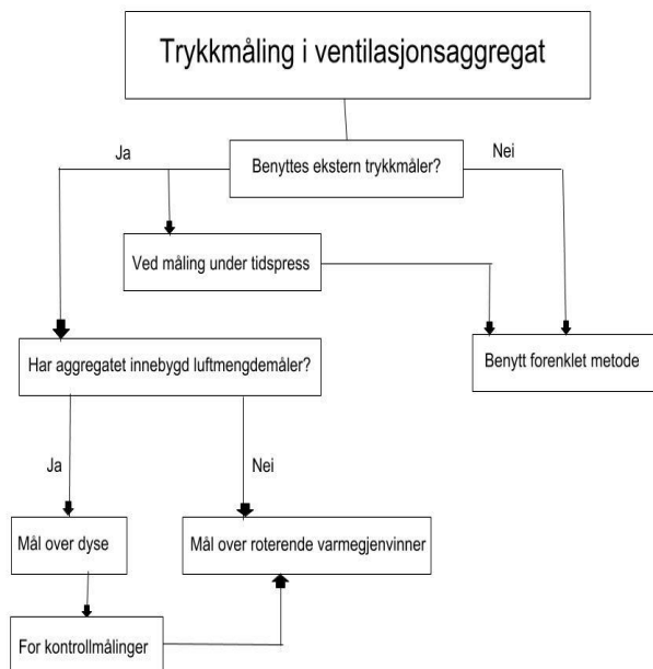
Figur 7: Flytskjema for valg av metode [E. Sørbotten].
