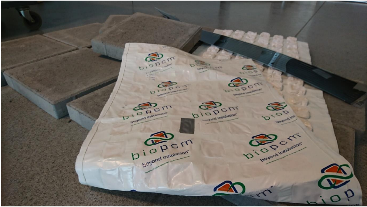
Figur 16. Pcm matte, betongheller og en del av varmefolier.
