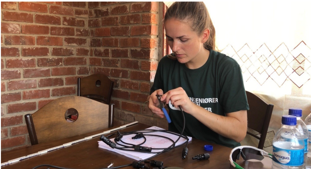
Figur 3.1: For å få PV-modulene til å passe sammen i den konfigurasjonen vi ønsket måtte ledninger skjøtes og loddes
